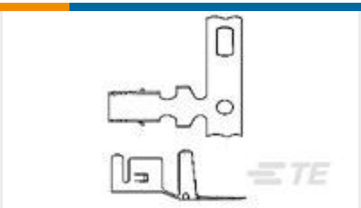
TE Part # 3-794037-1 MINI AMP-IN PTP PHBZ 10AWG
