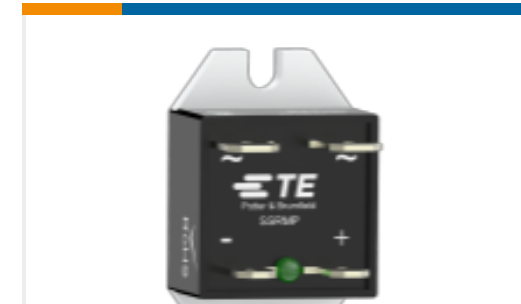
TE Part # 2323802-3 SSRMP-240D10 = Mini Puck,10A,240V AC
