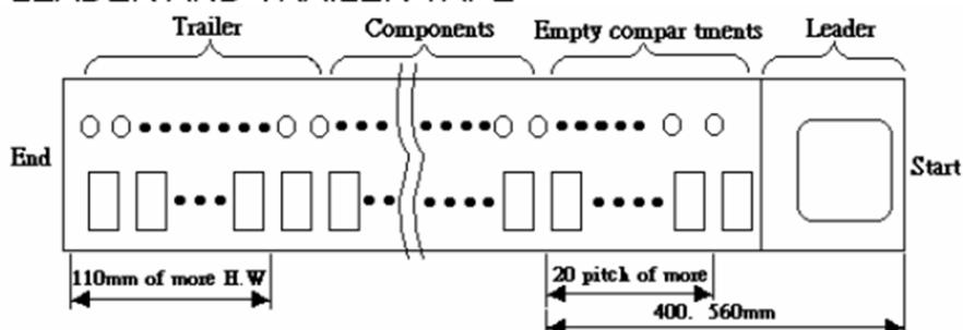
10-3 DIRECTION THE DIRECTION SHALL BE SEEN FROM THE TOP OF COVER TAPE
