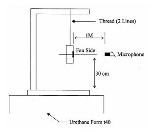
1 METER FROM MICROPHONE TO FAN INTAKE
