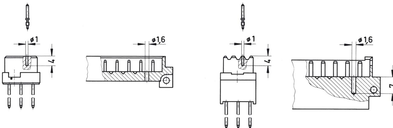
Forare il connettore maschio in un punto pre-centrato come da disegno. Con l'ausilio dell'utensile di montaggio, inserire il perno di codifica nella relativa cavità del connettore femmina. Questo sistema di codifica è disponibile solamente per i tipi D, E, F e connettori di interfaccia I.
