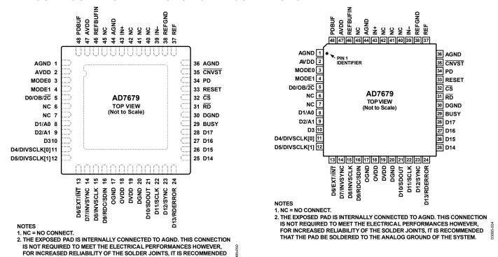
THAT THE PAD BE SOLDERED TO THE ANALOG GROUND OF THE SYSTEM.
