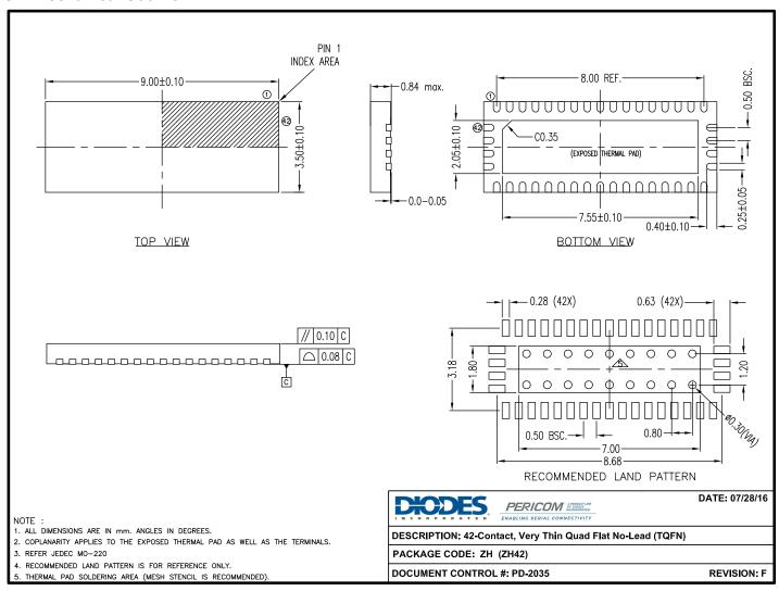
Figure 8-1 42-contact TQFN (ZH42) Package Mechanical Drawing
