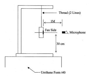
1 METER FROM MICROPHONE TO FAN INTAKE
