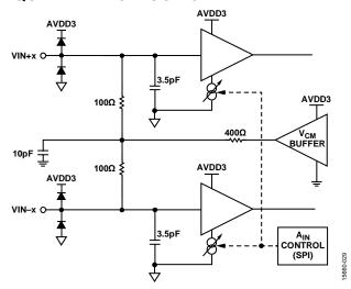
Figure 57. Analog Inputs
