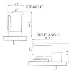
P.Cボード穴寸法 P.C.BOARD THROUGH HOLE DIMENSION
