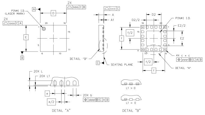
Figure 16. 20-Pin Quad Flat No-Lead (QFN)
