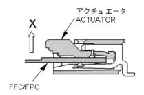
2.大きな衝撃が加わる機器に使用する場合は、右図の様に コネクターとシャーシーなどの隙間に、弾力性の有る物を 挟み込み、アクチュエータの浮き上がり防止を行って下さい。
