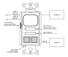
FIGURE 3 - ULTRASONIC, DUAL CIRCUIT, **NEUTRAL CONNECTION**
