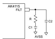
Figure 27. PLL Loop Filter
