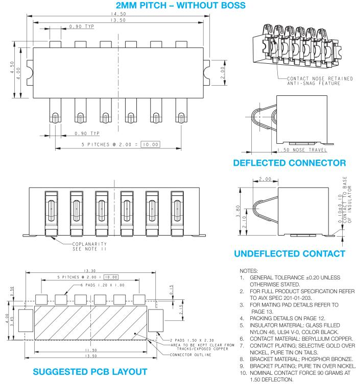
**6 WAY BATTERY CONNECTOR – RIGHT ANGLE**
