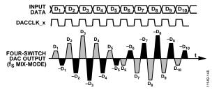
Figure 145. Mix-Mode Waveform
